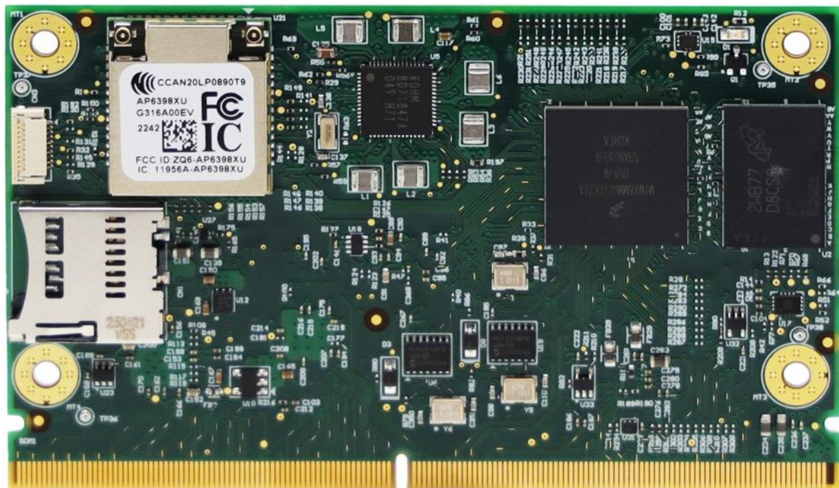
Figure 1-6 VEST i.MX 8M Nano SOM Front Side View
